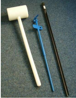
Pürckhauer Bohrstock mit Kunststoffhammer und Ziehgerät.
