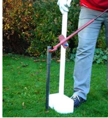
Ziehvorgang des Bohrstocke
